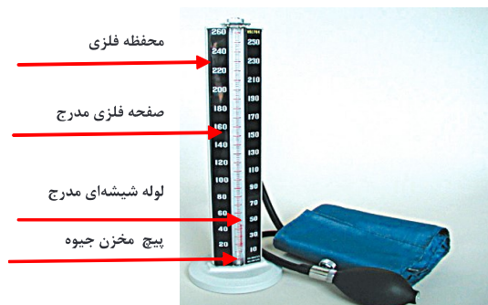
شکل ۷: دستگاه فشار سنج جیوه‌ای (mercury monitor)
